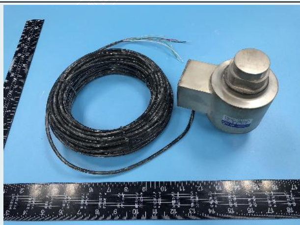
图1-15 防尘试验后外观检查 (4#)
