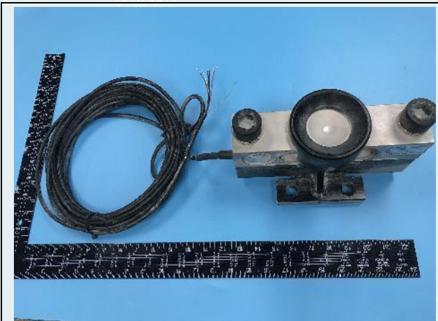
图1-9 防尘试验后外观检查 (1#)
