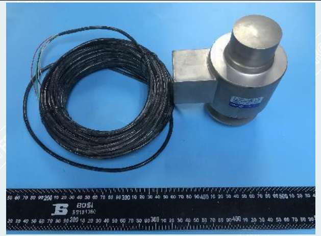
图1-14 防水试验后外观检查 (3#)
