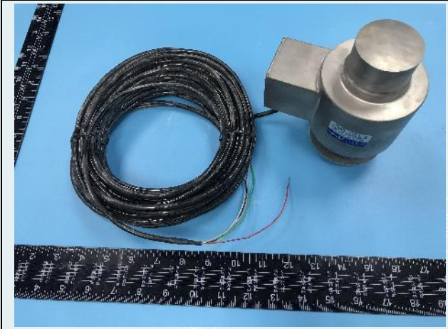
图1-13 防尘试验后外观检查 (3#)
