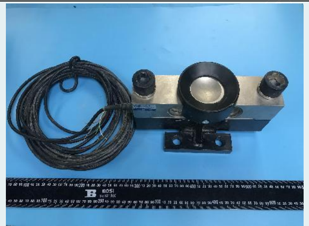
图1-12 防水试验后外观检查 (2#)
