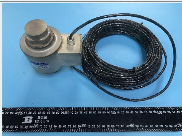
图1-16 防水试验后外观检查 (4#)
