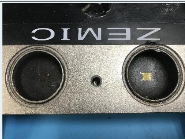
图1-18 防水试验后内部检查 (2# 正面)
