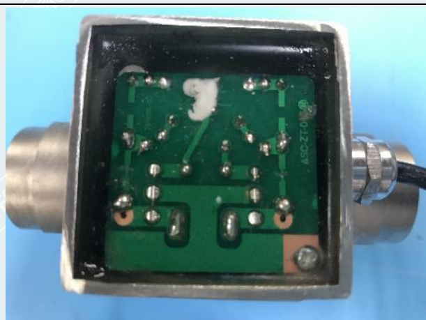
图1-20 防水试验后内部检查 (4#)
