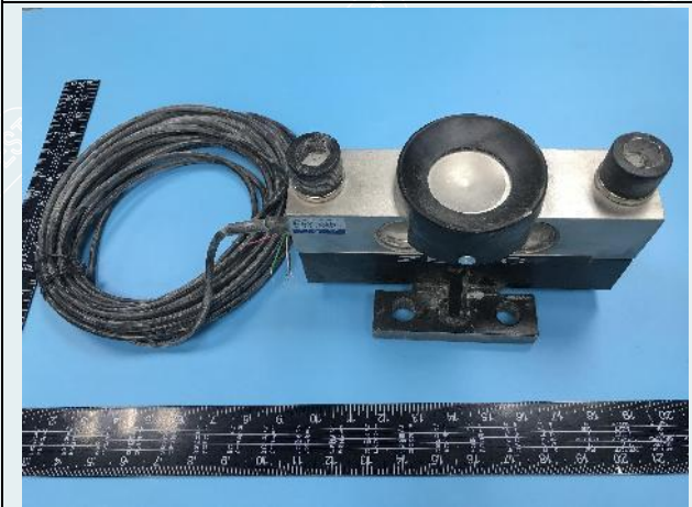
图1-11 防尘试验后外观检查 (2#)
