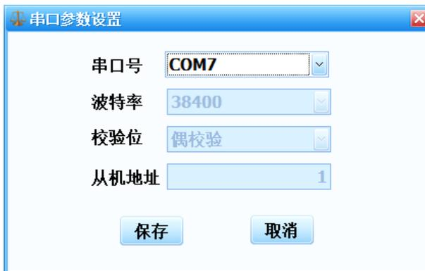
如果串口号选择错误，将无法与仪表通讯，进而无法采集重量和通过系统操作仪表，并且在实时称重显示窗口显示端口号错误信息。
